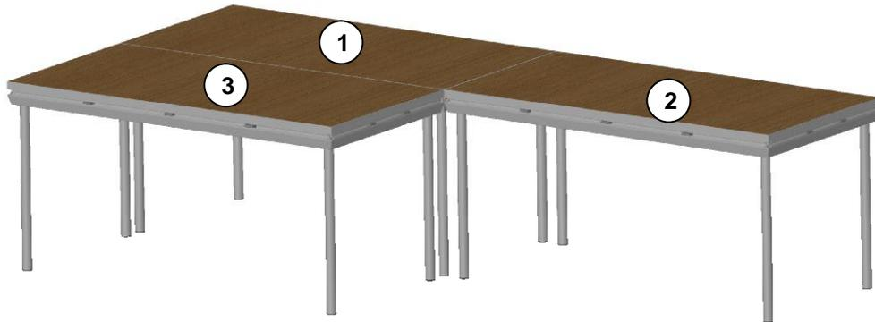
Insérer l'ensemble des pièces de jonction de mise à niveau (Réf. C0013) suivant l'étape 1.
