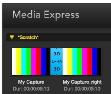
In der Miniaturansicht sind die Clips für das rechte und das linke Auge mittels 3D-Indikator verknüpft und werden in Form eines einzelnen, großen Symbols angezeigt
